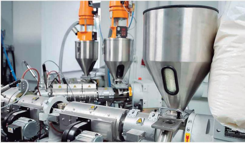
Con nuestras máquinas de extrusión, podrás fundir y moldear el plástico a flujo constante de fuerza, para obtener la forma deseada del polímero.
